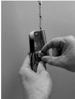
Drehen Sie die Rändelmutter nach links bis diese komplett frei ist. Drücken Sie den Sicherungshebel nach unten und öffnen Sie das Auffanggerät.
