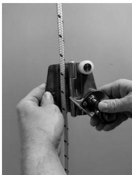
Legen Sie das Seil in die geöffneten Gehäusehälften ein. Klappen die das mitlaufende Auffanggerät zusammen.
