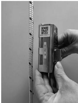
Achten Sie auf die korrekte Laufrichtung. Die Laufrichtung ist durch zwei Markierungen kenntlich gemacht. Ein Aufkleber sowie ein gelasertes Pfeil sind als Markierung angebracht.
